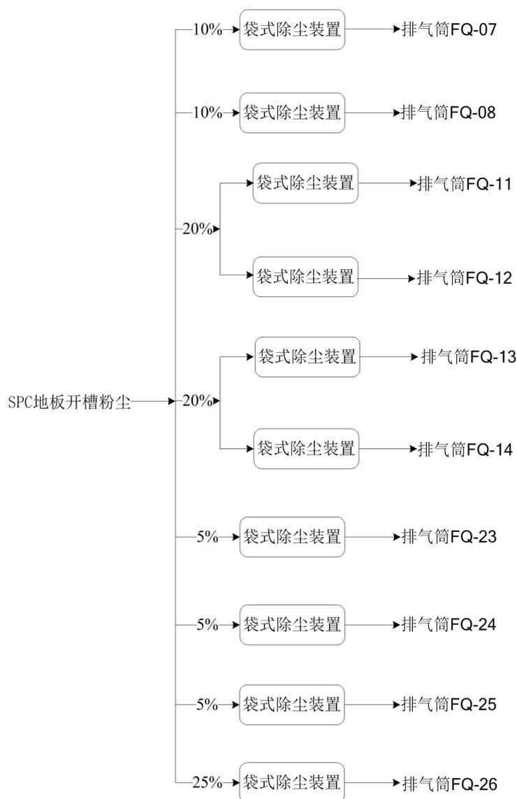
图 3-18 本项目 SPC 地板开槽粉尘产污图
