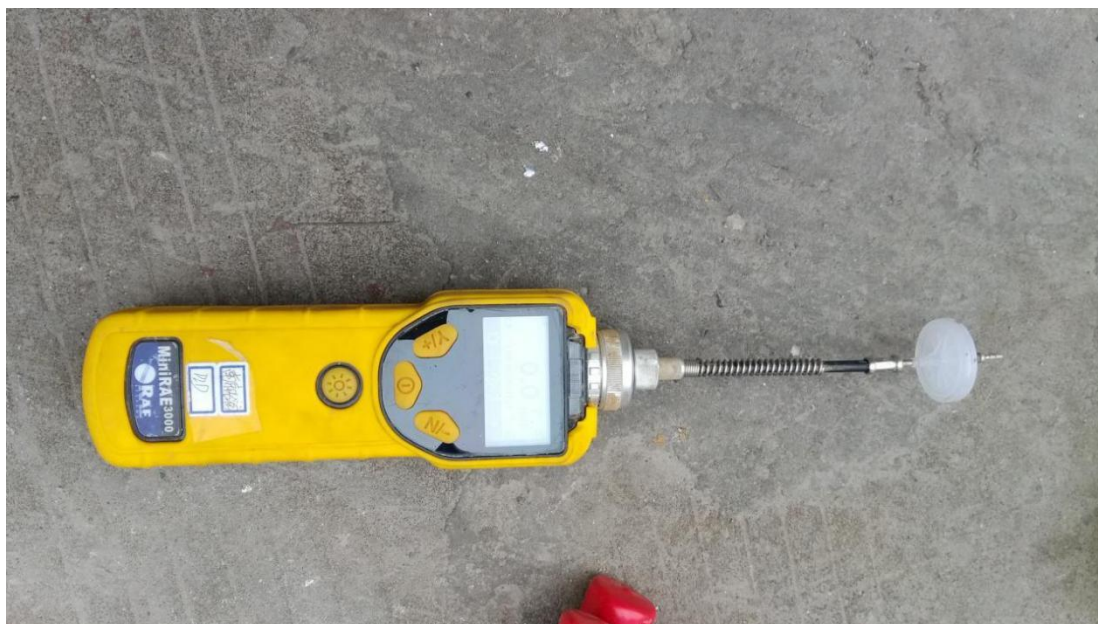
图 9.4.2-2 PID 快速检测设备
