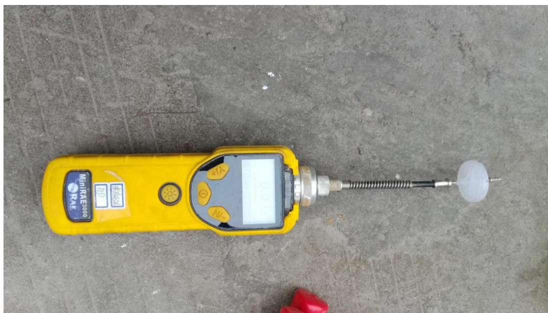
图 9.4.2-2 PID 快速检测设备
