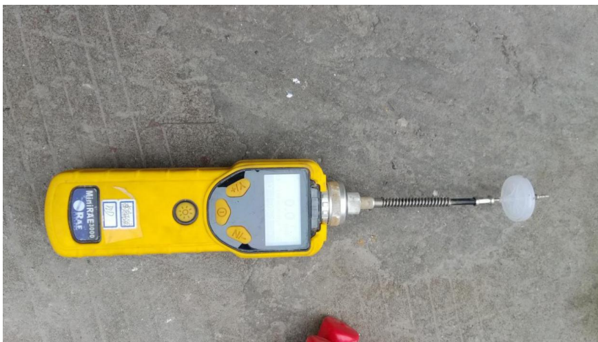
图 9.4.2-2 PID 快速检测设备
